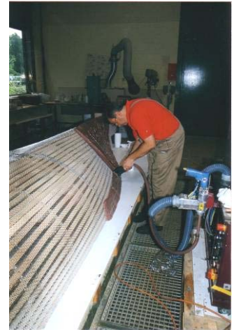
Hamburgische Schiffsbauver- suchsanstalt; Alternative im Bootsbau: Korpus aus FORMETAL YPSILON & Sika Kunstharz
