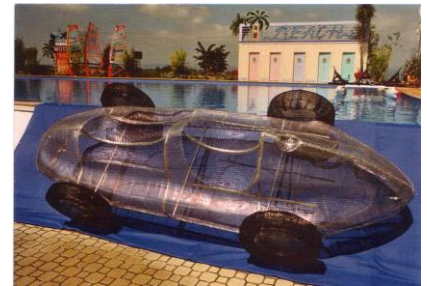
Chassis aus FORMETAL YPSILON inkl. Reifen; Abformung Kohlefaserchassis „Veritas Meteor“ (Rennwagen aus den 50er-Jahren)
