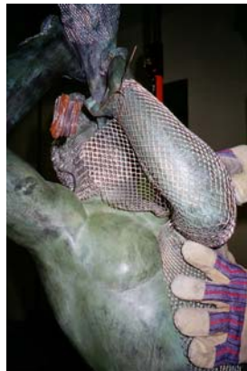
Per Hand wird FORMETAL VARIUS an die Form des Originals angepasst.
