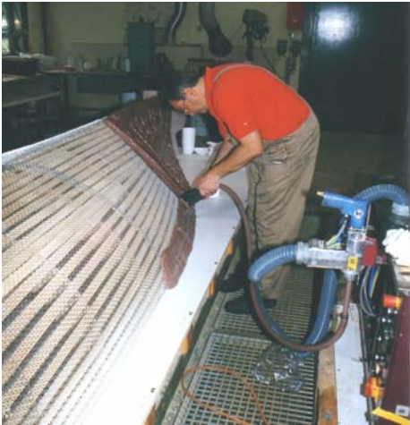
Hamburgische Schiffsbauversuchsanstalt; Alternative im Bootsbau: Korpus aus FORMETAL YPSILON & Sika Kunstharz
