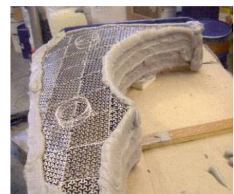
Leichtbauteil mit FORMETAL YPSILON und Alufix Modellbausystem, gecovert mit selbsthärtender Kunststoffmasse © Horst WITTE Gerätebau
